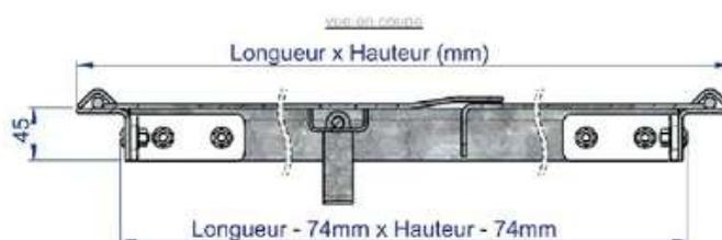
**\*Avertissement :** La galvanisation à chaud est susceptible de produire des déformations sur les pièces métalliques. Une parfaite planéité des ouvrants ne peut donc être garantie. Notre contrôle qualité veille à ce que les ouvrants soient ajustés et qu'ils ne produisent jamais de ressaut supérieur à 2 centimètres. Aucune réclamation ne pourra être acceptée sur les déformations en deçà de ce seuil de tolérance.
